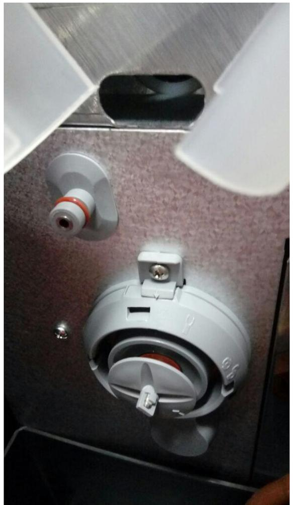
Após instalado o bico basta montar novamente o mixer.
