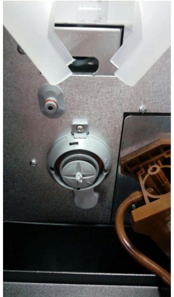
Sugestão: colocar um bico (cód. 1100.8877) para diminuir o diâmetro da saída, aumentando a pressão da água, melhorando a distribuição da água dentro do mixer.
